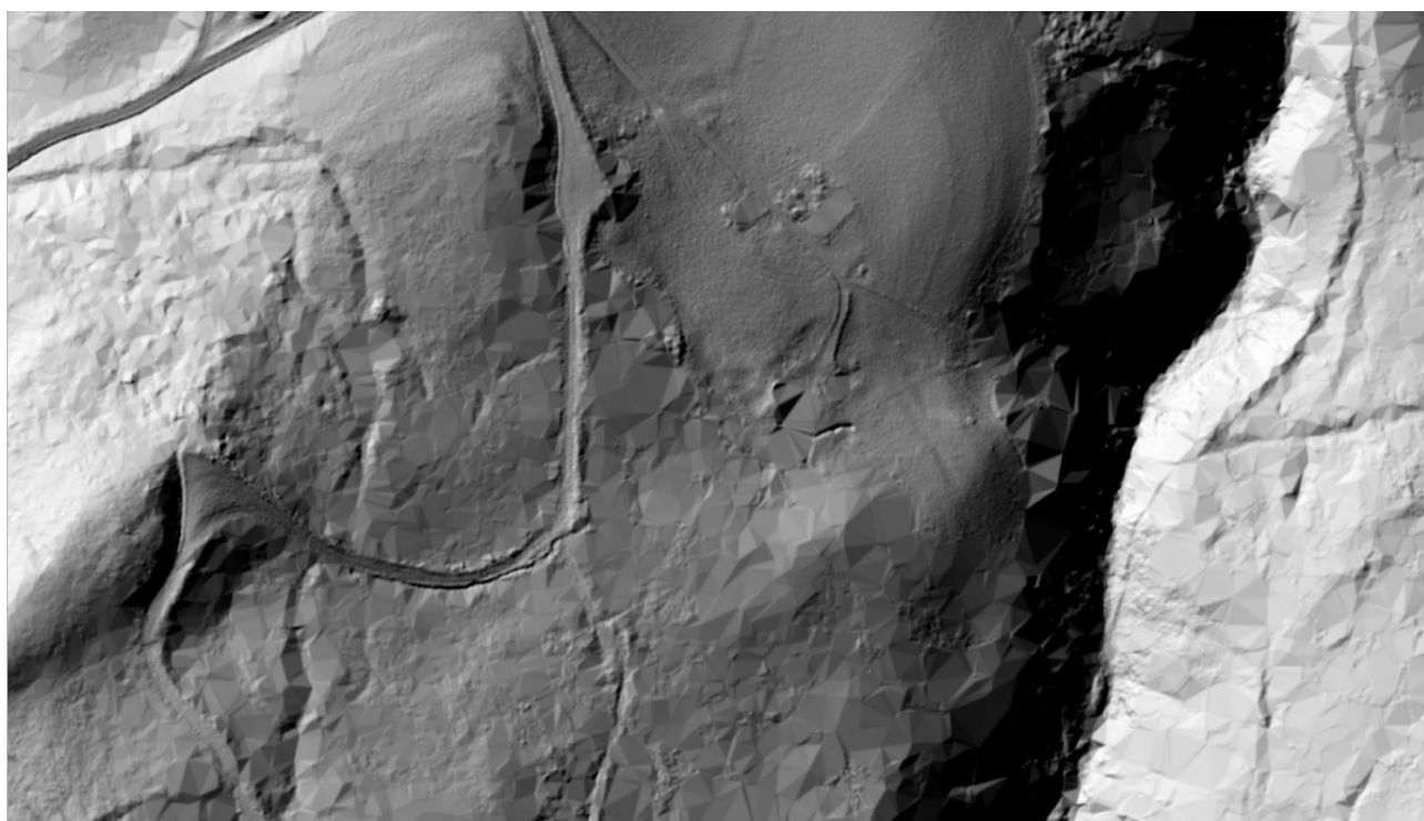
Figure 5: Ombrage du MNT classé du LIDARHD sur le replat morainique du Mont Galland : les zones sous couvert forestier présentent des « facettes » qui sont liées à la faible densité de points classifiés au sol. L'interpolation importante entre ces points dégrade la précision du MNT.
