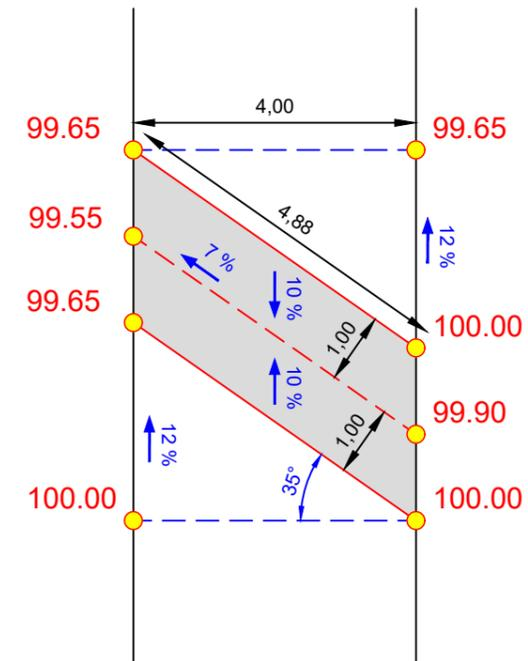
Vue en plan sur renvoi d'eau bétonné
